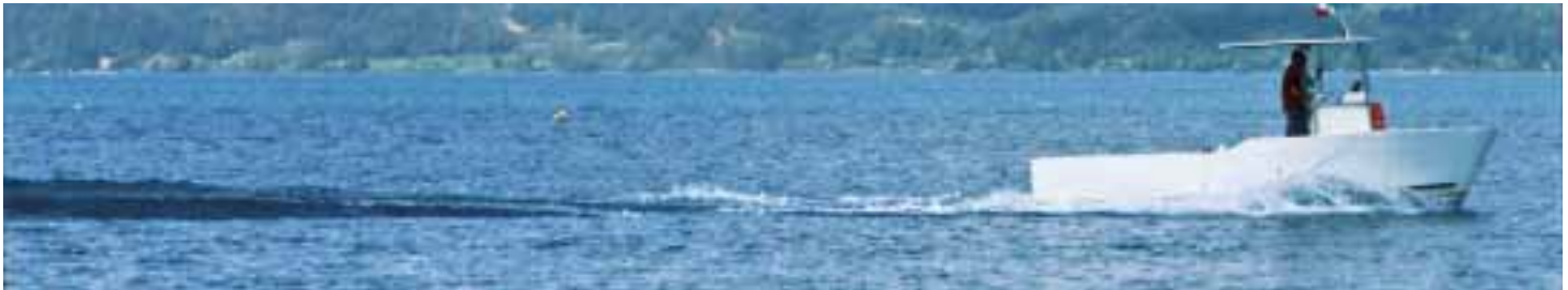
Figura 7a (sopra)- 4 kn sul modello di 8,10 metri corrispondenti a 7 kn per un MonoTriCat® di 21 metri al galleggiamento. Siamo in regime dislocante. Figura 7b (sotto)- 14 kn sul modello di 8,10 metri corrispondenti a 23 kn per un MonoTriCat® di 21 metri al galleggiamento. Nonostante siamo in pieno regime semiplanante la formazione ondosa resta contenuta e l'assetto di navigazione resta pressoché orizzontale.
