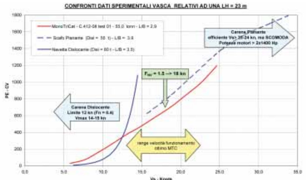
Figura 7 - Range di funzionamento idrodinamici ottimi delle tre tipologie di carena ipotizzando uno scafo di circa 23 metri fuori tutto (75 piedi).
